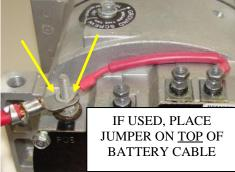
SEE INSTRUCTION SHEET ON  $\underline{www.delcoremy.com}$  WEBSITE FOR MORE DETAILS ON REMOTE SENSE JUMPER LEAD INSTALLATION.
